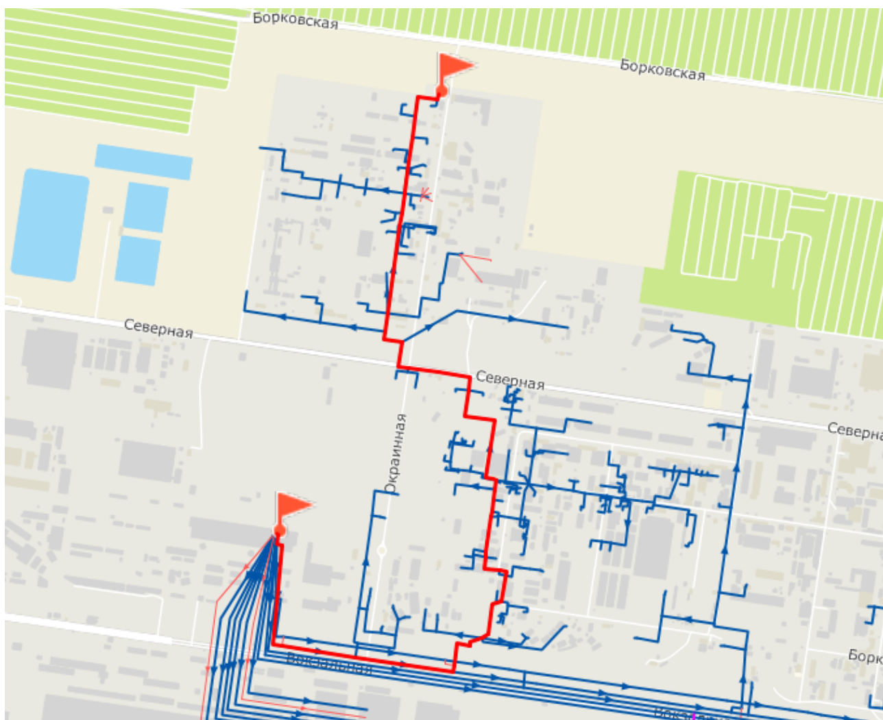
Рисунок 2.3 - Путь теплоносителя по направлению от ТЭЦ ВАЗ до потребителя «ул.Окраинная 1»
