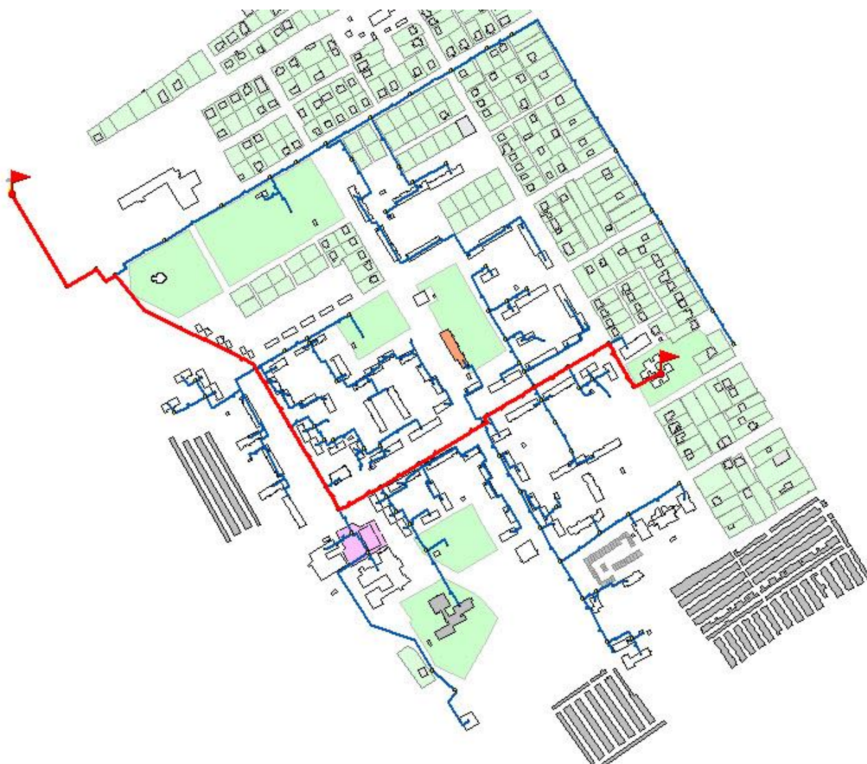
Рисунок 39 – Направление № 2 от котельной БМК-34 (Н2)
