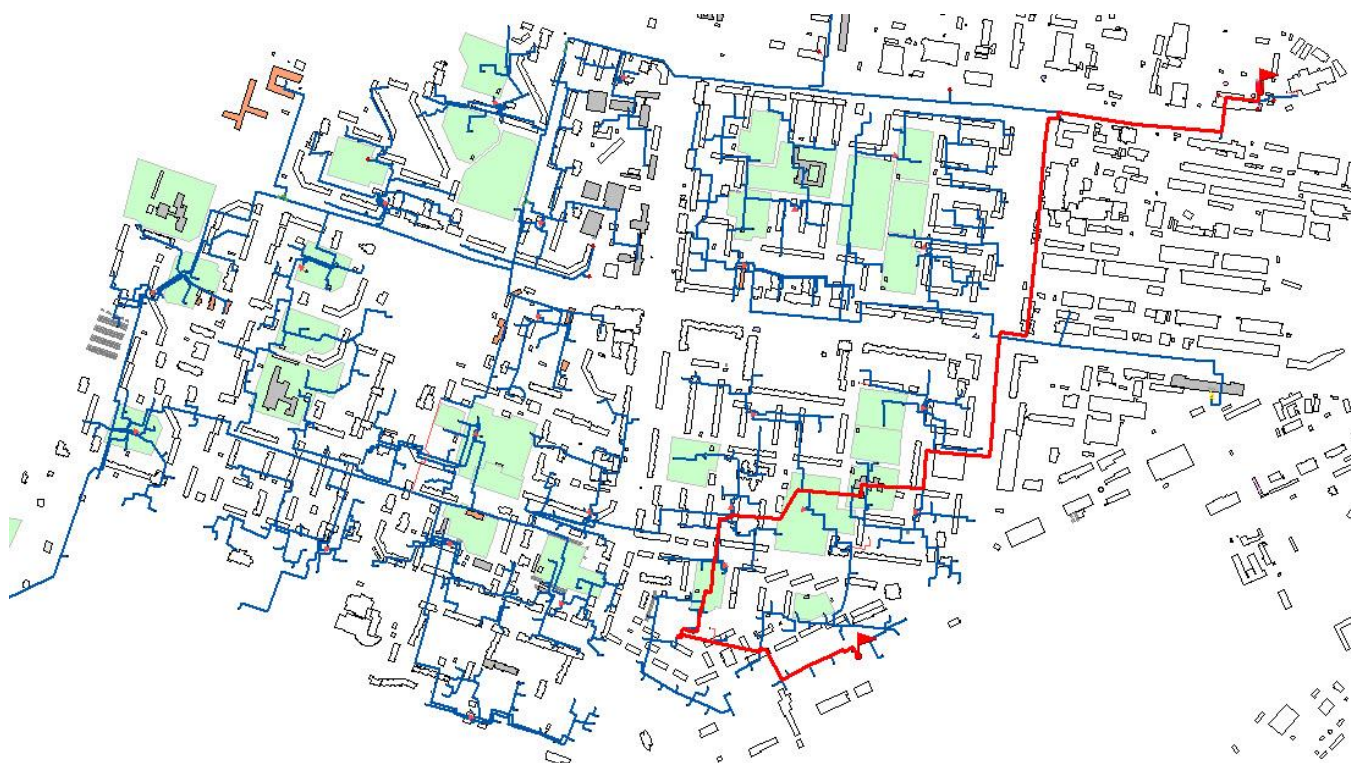
Рисунок 43 – Направление № 1 от Котельной № 2 (Н1)
