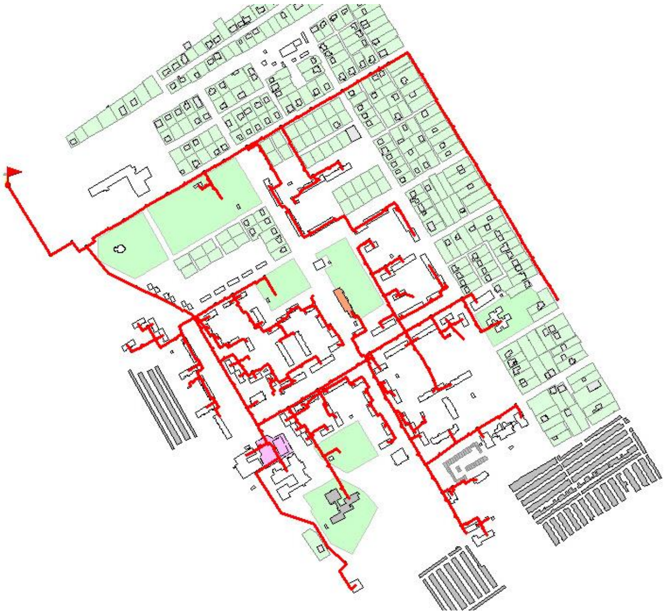
Рисунок 37 – Тепловая сеть от котельной БМК-34
