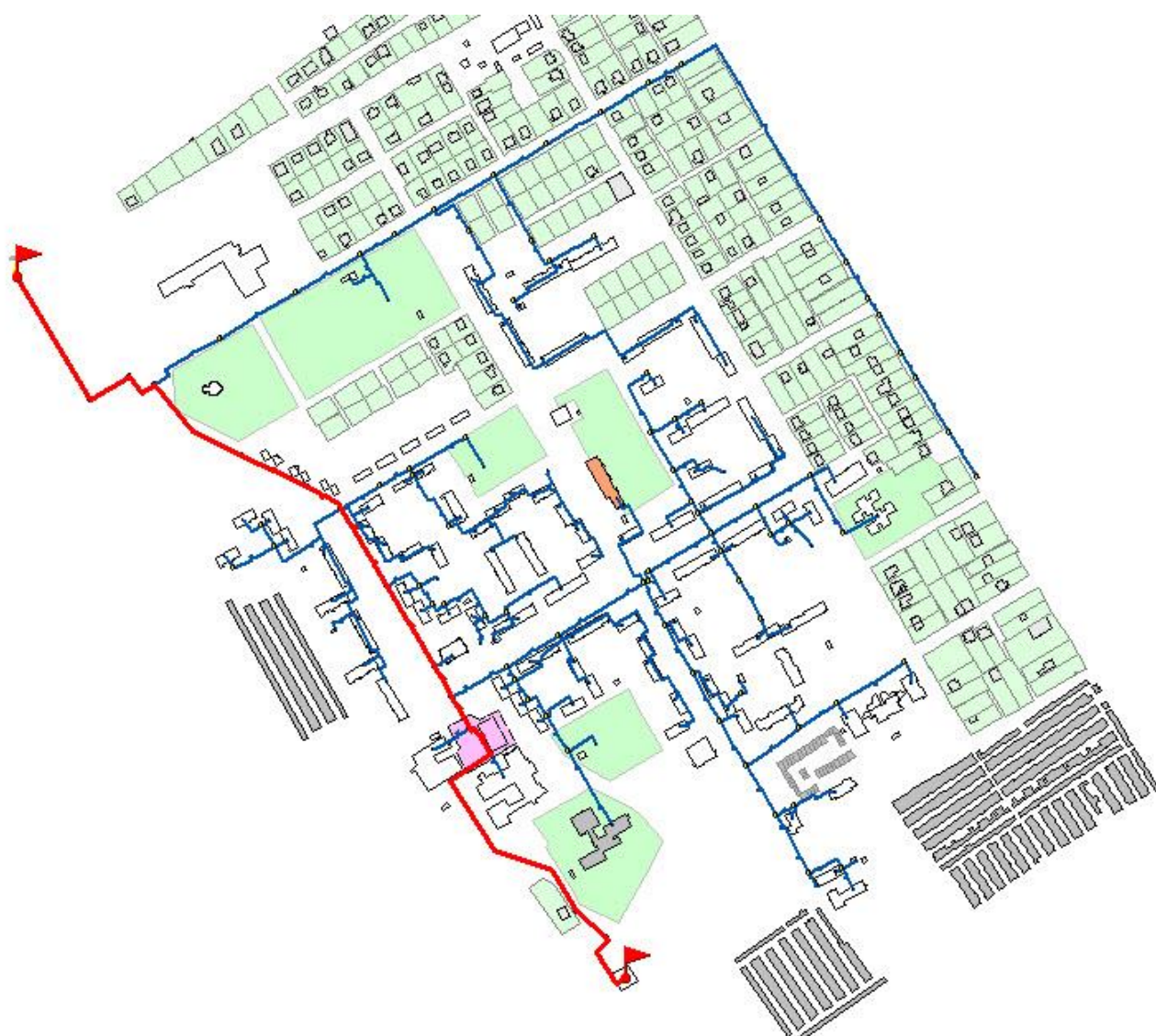
Рисунок 41 – Направление № 4 от котельной БМК-34 (Н4)
