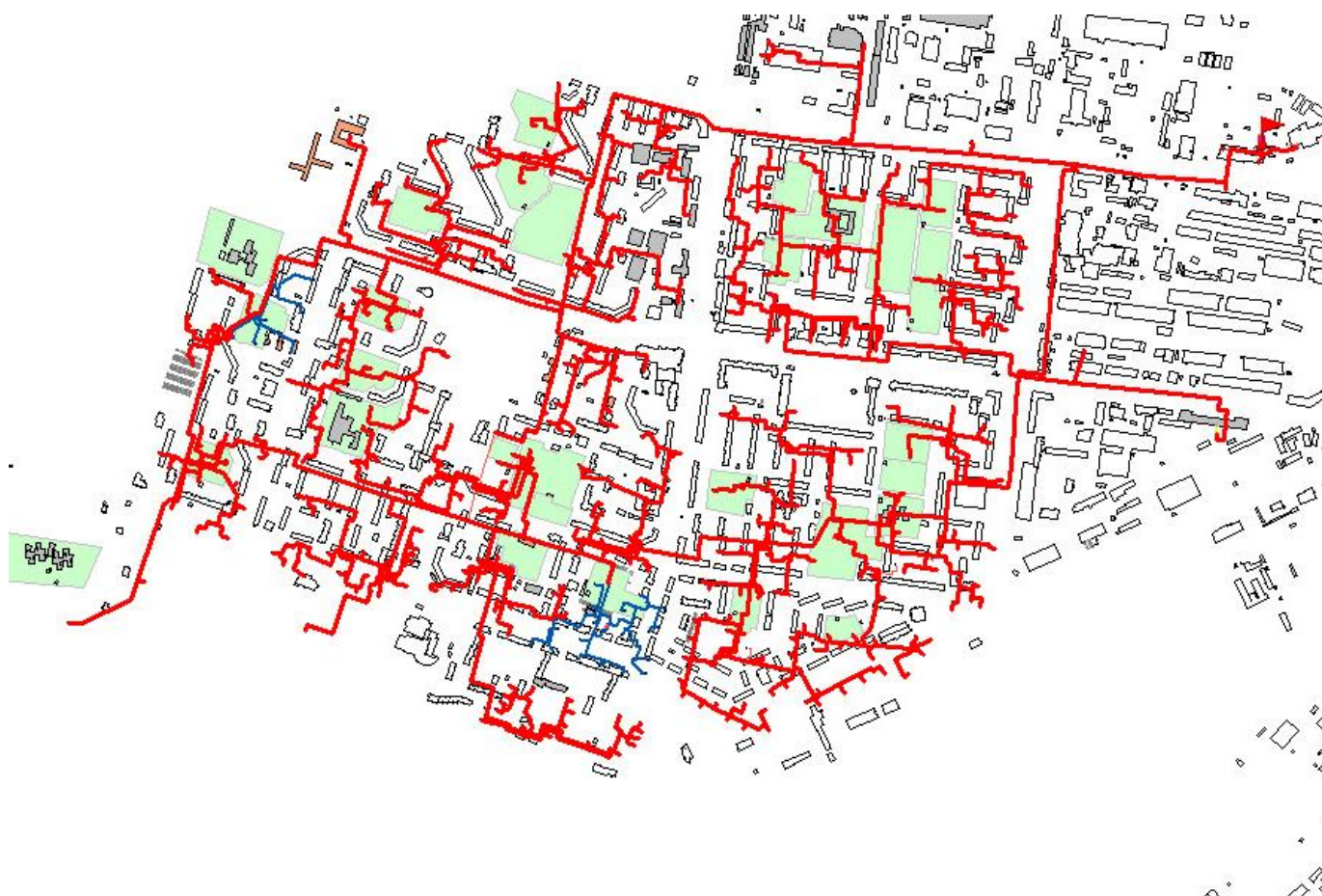
Рисунок 42 – Тепловая сеть от Котельной № 2
